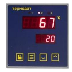
Рис. 4. Лицевая панель измерителя-регулятора сейфа-термостата.
